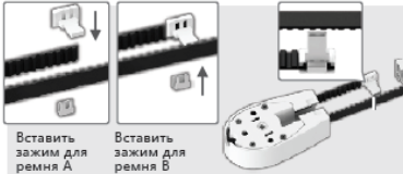
10. Установите зажим для ремня А и зажим для ремня В, затем вставьте в мастерглайдер зажим А.
