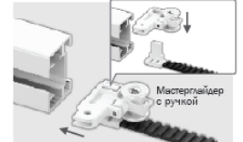
5. Установите в мастерглайдер зажим А, затем установите его на направляющую.
