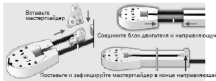
11. Вставьте мастерглайдер и зажимы ремня в направляющую, как показано на рисунке, переместите их в конец другой стороны направляющей, отрежьте лишнюю часть ремня.
