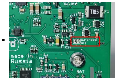
Wiren Board 7.2. Запаять перемычку Watchdog OFF
