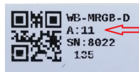
Modbus-адрес, установленный на производстве
