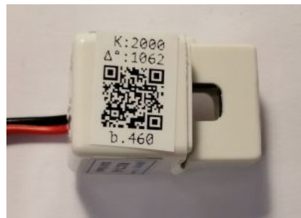
Пример наклейки с параметрами. Коэффициент трансформации - 2000. фазовый сдвиг - 1062
