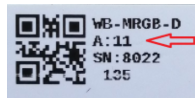
Modbus-адрес, установленный на производстве
