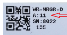
Modbus-адрес, установленный на производстве
