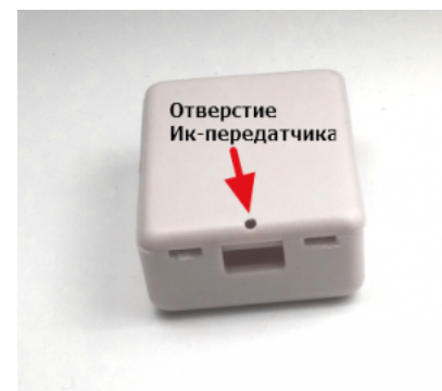
Отверстие ИК-передатчика на задней стороне модуля
