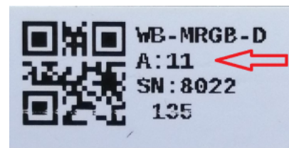
Modbus-адрес, установленный на производстве
