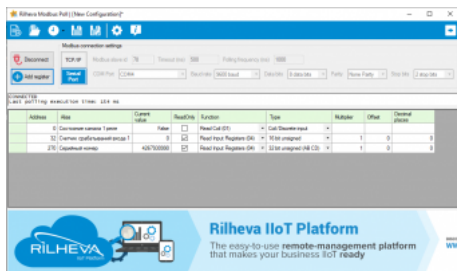
Опрос регистров устройства Wirenboard
