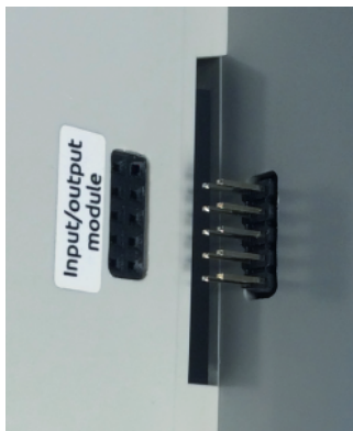
Подключение модуля ввода-вывода к контроллеру
