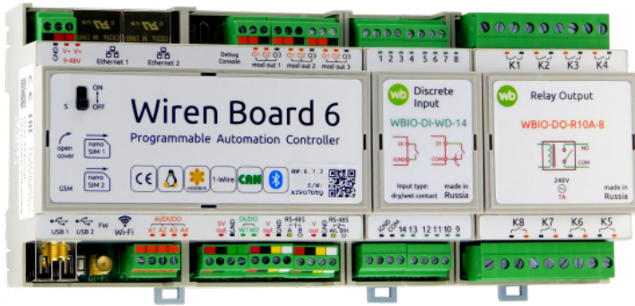
Контроллер Wiren Board 6 с боковыми модулями
