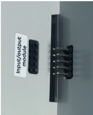
Подключение модуля ввода-вывода к контроллеру
