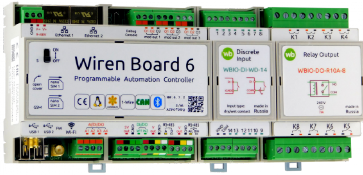
Контроллер Wiren Board 6 с боковыми модулями
