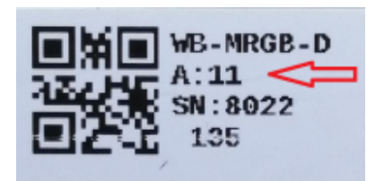
Modbus-адрес, установленный на производстве
