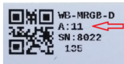
Modbus-адрес, установленный на производстве
