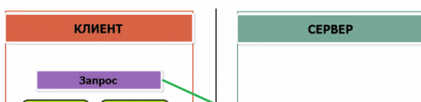
Modbus-транзакция, прошедшая без ошибок
