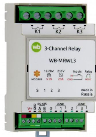
Релейный модуль WB-MRWL3
