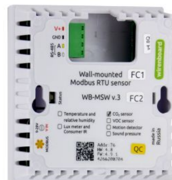
Универсальный датчик WB-MSW v.3, вид сзади. Виден список возможных опций и назначение контактов на винтовых разъёмах
