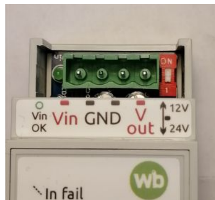
Выбор напряжения питания/стабилизации, микропереключатель установлен в положение «24 В»
