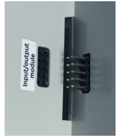
Подключение модуля к контроллеру
