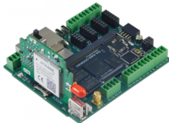
Установка модуля WBC-4G v.2 в контроллер Wiren Board 7
