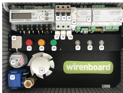
Компоненты, расположенные на нижней крышке WB-demo-kit
