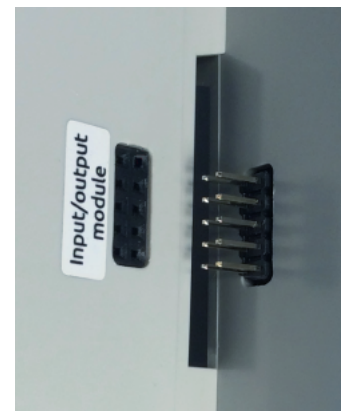
Подключение модуля ввода-вывода к контроллеру
