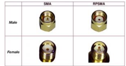
Сравнение разъемов для антенн Wi-Fi (RP-SMA) и GSM (SMA)
