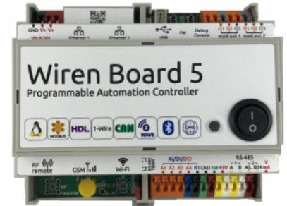
Выключатель на верхней крышке контроллера
