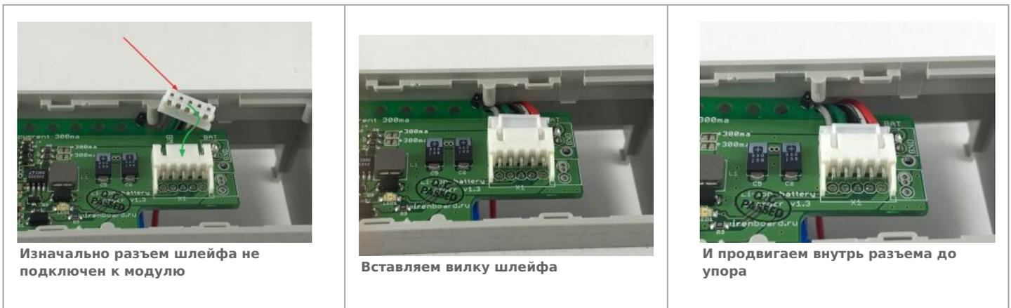
Изначально разъем шлейфа не подключен к модулю
