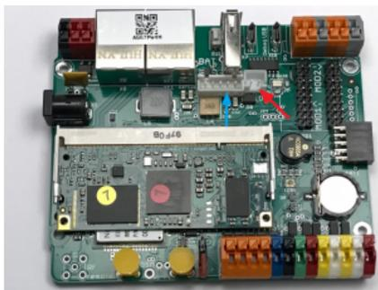
Плата контроллера с разъемами для аккумулятора и выключателя
