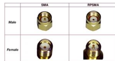
Сравнение разъёмов для антенн Wi-Fi (RP-SMA) и GSM (SMA)
