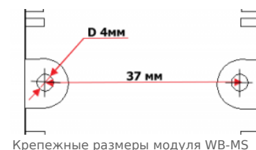
Крепёжные размеры модуля WB-MS
